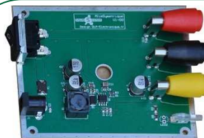
Inverseur tension alimentation Permet de créer une tension négative
