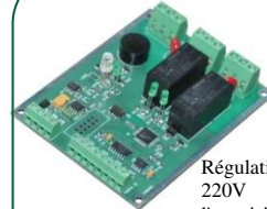
Contrôleur chauffage / thermocouple
